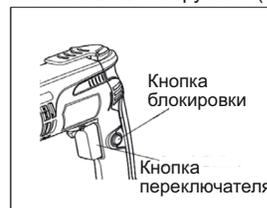
Для непрерывной работы нажмите курковый переключатель, а затем нажмите кнопку блокировки. Чтобы остановить инструмент из заблокированного положения, полностью нажмите курковый переключатель, а затем отпустите его. (Рис. 2)
